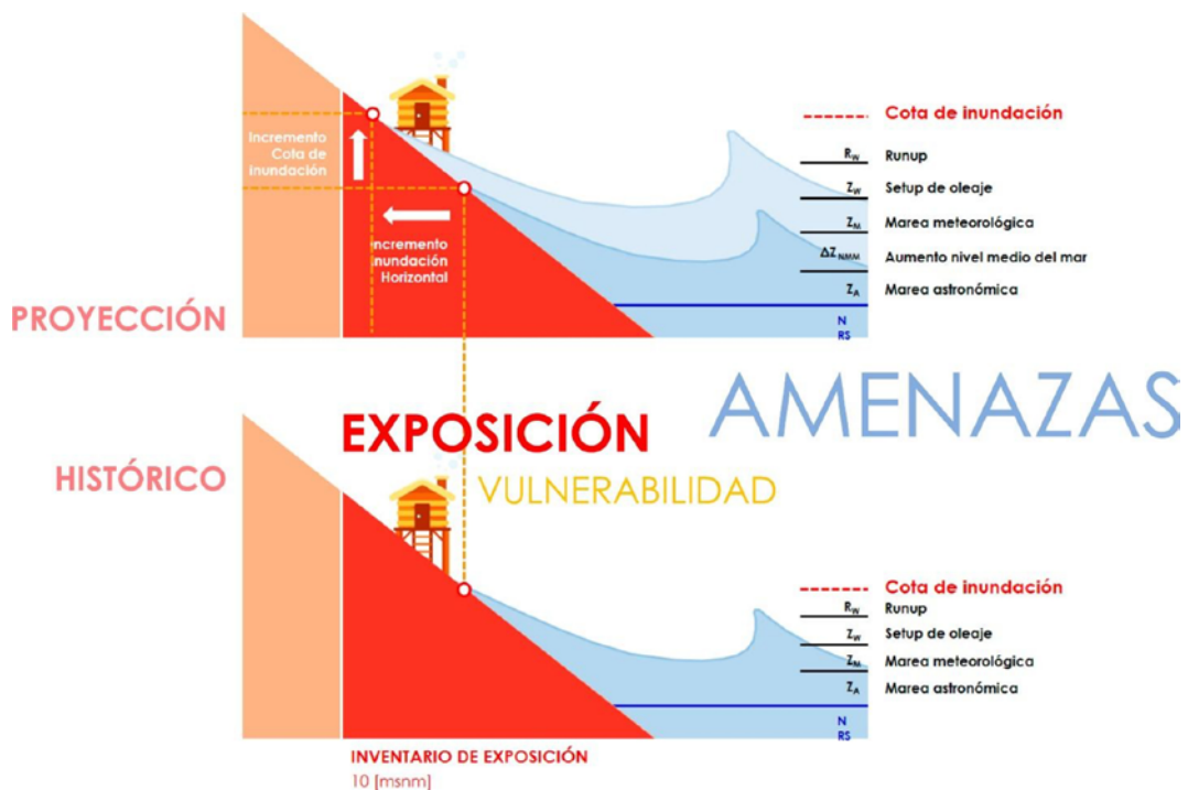
Figura N°3. Modelo del riesgo de inundación costera. La amenaza se calcula mediante la cota de inundación, que surge de la superposición del runup y setup de oleaje, la marea astronómica y la marea meteorológica. La exposición se define por aquellos elementos ubicados bajo los 10 msnm. La vulnerabilidad depende de la propensión de un sistema, representado por una casa, a ser afectado negativamente
