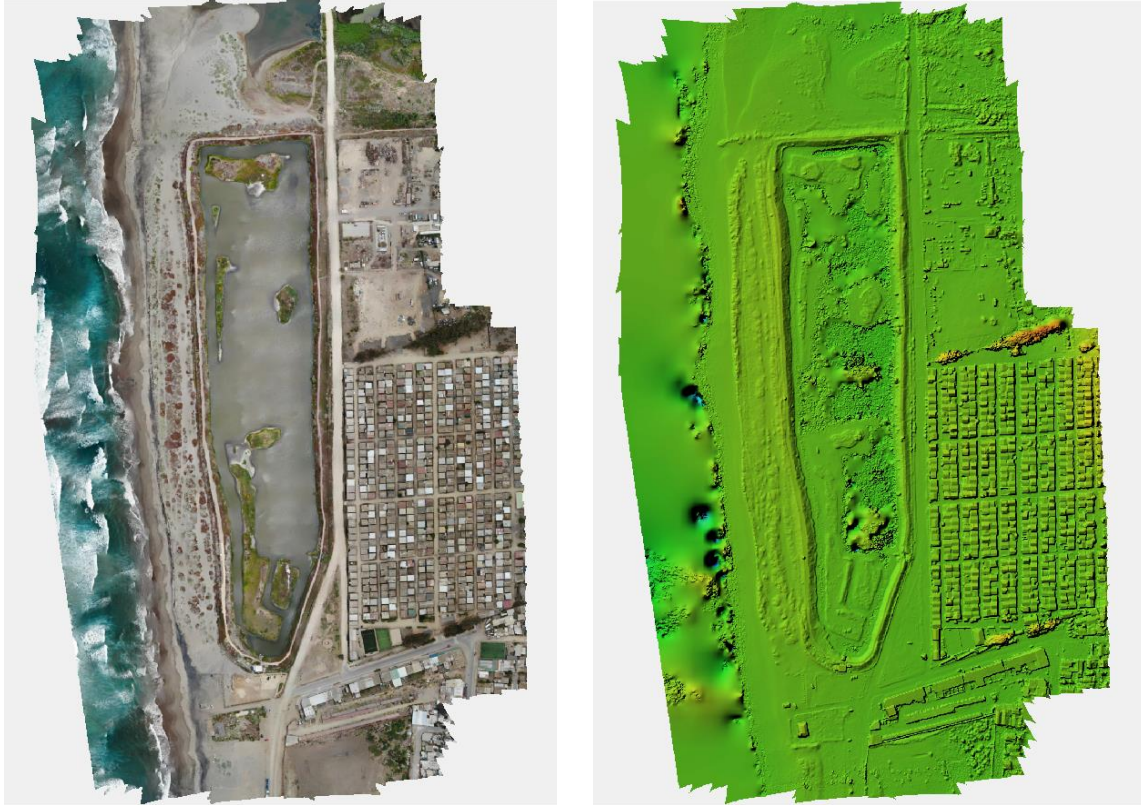
Figura 11. Ejemplo de ortomosaico [izquierda] y modelo de elevación digital [derecha] generado para el humedal Cartagena. En este caso, cada producto posee una resolución de 3 centímetros, lo que permite trabajar a escala de 1:150 aproximadamente.
